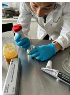
1-сүрөт. Канттуулукту рефрактометр менен өлчөө; 2-сүрөт. Ширенин кычкылдуулугун өлчөө(Ph метр)
