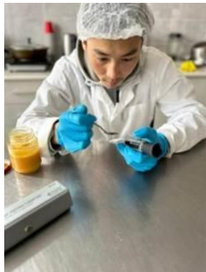
1-сүрөт. Канттуулукту рефрактометр менен өлчөө; 2-сүрөт. Ширенин кычкылдуулугун өлчөө(Ph метр)
